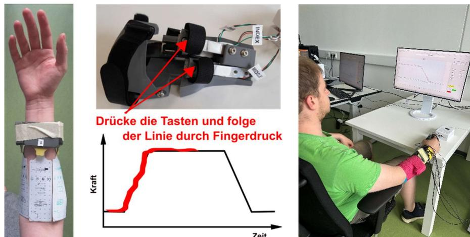
Abb. 1: Links: Pflasterartige Sensoren (Elektroden) über dem Unterarm. Mitte: Seitenansicht der ergonomische Maus mit zu folgender Linie. Rechts: Der Teilnehmer bedient die Maus, um einer Führungslinie auf dem Bildschirm zu folgen.
